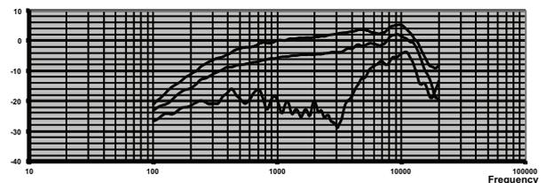
Réponse en fréquence (angle d'ouverture : 0, 90 et 180 degrés)
